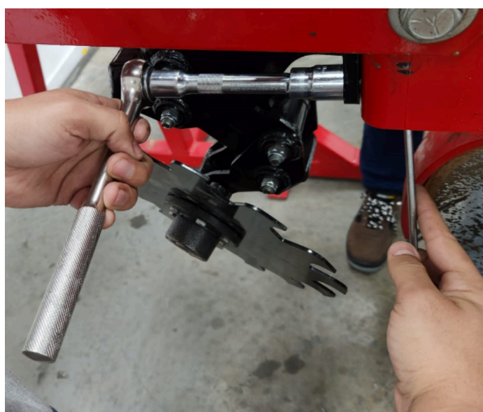
Colocación de bulones inferiores.
