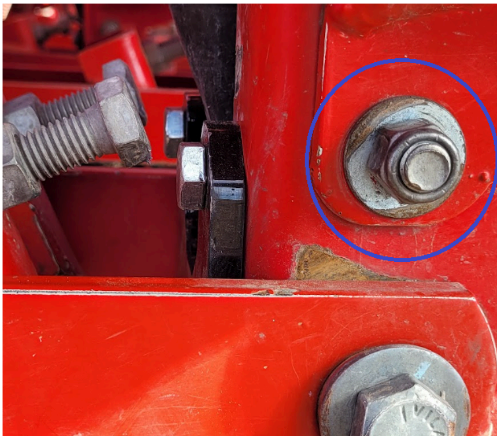
Posición correcta del bulón del soporte para la transmisión mecánica del dosificador.
