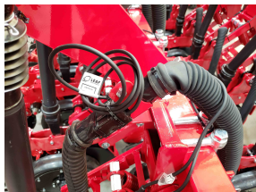
Sensores Radar de velocidad.
